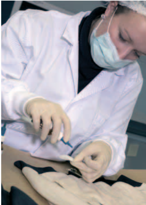
Illustratie 3: Om de aanwezigheid van bloed op stukken van overtuiging vast te stellen gebruikt men de tetrabasetest.
