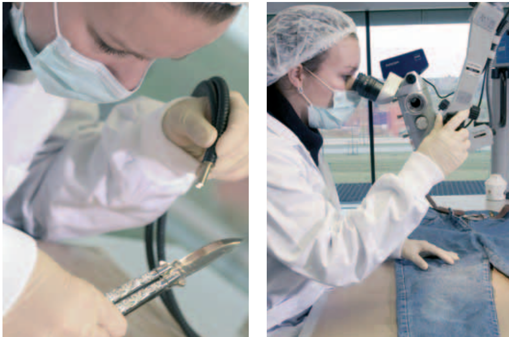
Illustratie 1 (links) en illustratie 2 (rechts): Bij het onderzoek van stukken van overtuiging naar biologische sporen (zoals bloed) maakt men gebruik van scheerlicht (illustratie 1) en een operatiemicroscopie (illustratie 2).
